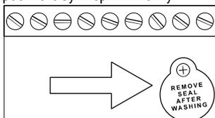
Отключить встроенный зуммер можно только механически – отпаяв его от платы или завинтив в отверстие зуммера винт M2,5 до упора.
